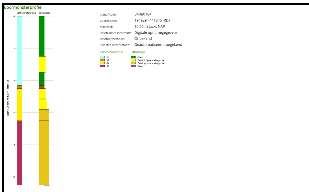
Figuur 7: Bodemprofiel volgens DINOLoket
