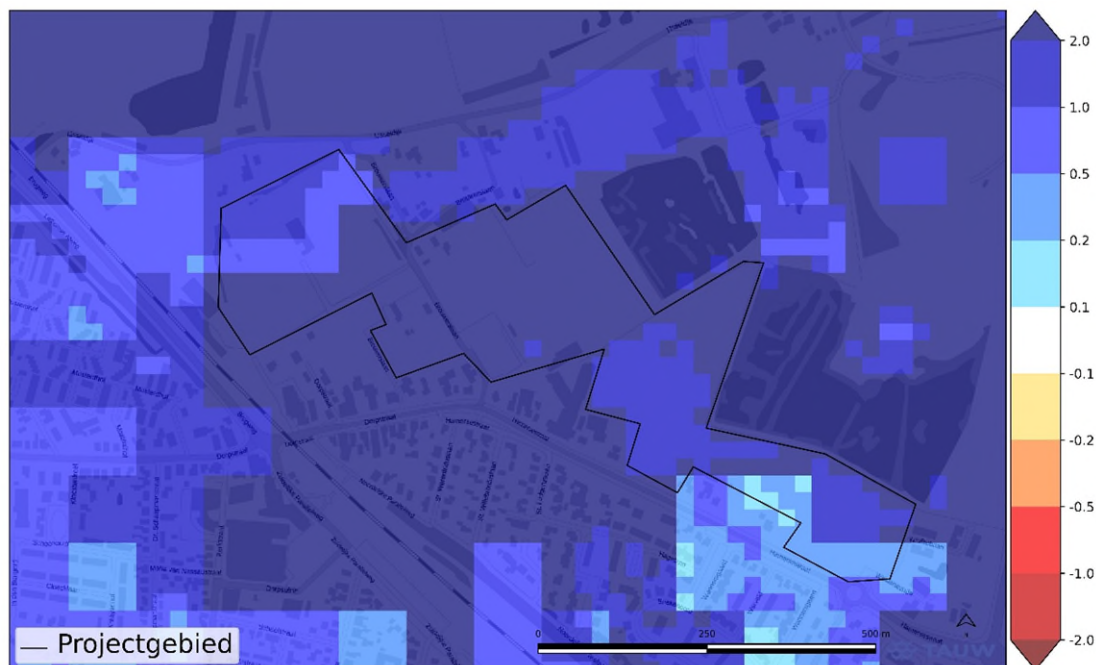
Figuur 6.6 Maximale kwelflux bij hoogwatersituatie in het plangebied Westervoort Noord
