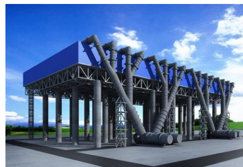
Figuur 7. Lage tafelkoelers versus hoge koeltorens
